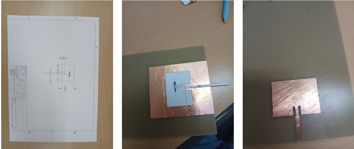
Figure 5: 제작과정-도면을 1:1축척으로 출력한다. 구리테이프를 먼저 붙이고 그 위에 출력한 도면을 덧댄다(폴로 살짝 붙인다). 그리고 칼로 기판에 흠집이 나지 않게 조심스레 자른다.
